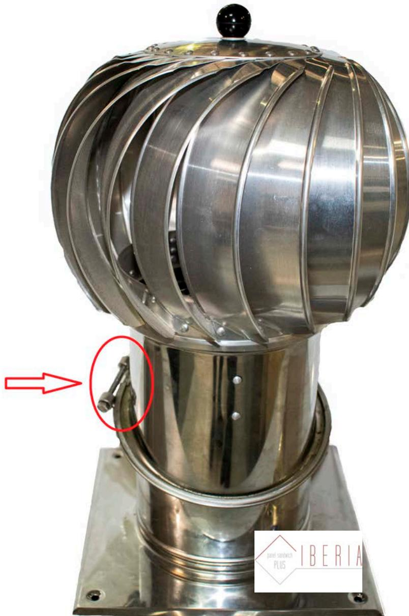
**Para conseguir la inclinación para la instalación en cubierta en pendiente, únicamente tendremos que aflojar el tornillo y girar el cuello hasta conseguir el ángulo requerido, y volver a apretar para fijarlo.**
